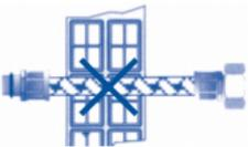
Non installare il flessibile in torsione o in tensione.
