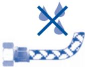
Installare il prodotto in ambienti idonei, puliti ed asciutti, PRIVI DI VAPORI DI PRODOTTI CHIMICI ecc., per evitare precoci fenomeni di corrosione e/o deterioramento dei materiali.
